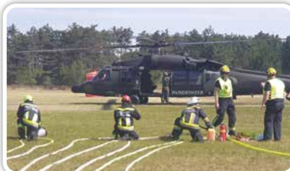
dem erst kürzlich angeschafften mobilen 10.000-Liter-Becken sowie dessen Betrieb eingesetzt. Von diesem Puffer aus, der laufend mit den im Pendelverkehr befindlichen Großtanklöschfahrzeugen befüllt wurde, wurde das Wasser dann über lange Versorgungsleitungen zu den Fahrzeugen der Riegelstellungen weitergepumpt, um eine unterbrechungsfreie Brandbekämpfung aller Brandherde sicherzustellen.
